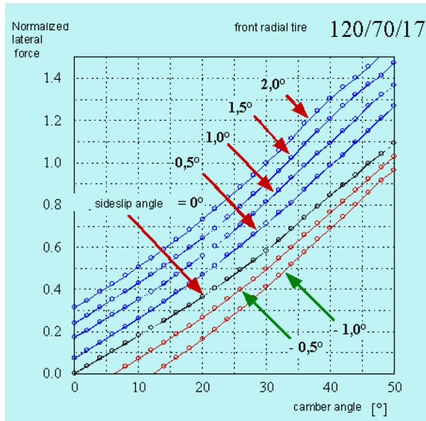
La fuerza lateral puede expresarse analíticamente como una función lineal del ángulo de inclinación y el side-slip angle, viendo la fuerza como la suma de dos componentes independientes entre si, la componente de la inclinación y la del side-slip.
