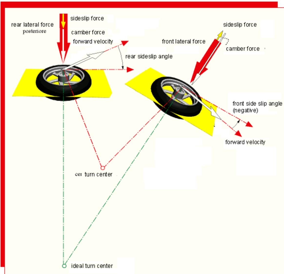
Podría ser posible utilizar un neumático delantero de una calidad mala y un buen neumático atrás. Sería un caso de deslizamiento lateral delantero grande y no-deslizamiento atrás. Esto provocaría que la motocicleta fuese mas subviradora. Esto es un problema porque en el caso de querer forzar la inclinada, se le esta pidiendo a la rueda delantera que aguante una fuerza lateral mas grande y por lo tanto se le pide un ángulo de derrapaje mucho mas grande.
