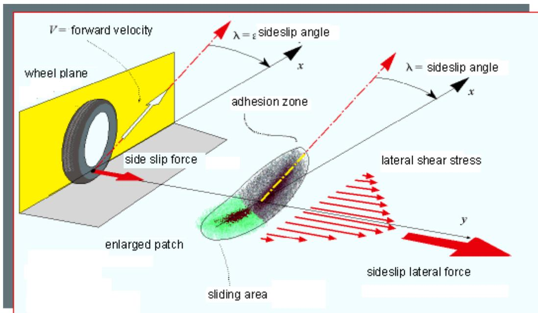
Hemos visto como la fuerza lateral depende del ángulo de inclinación y del deslizamiento lateral del neumático. Normalmente la fuerza lateral se representa con el side-slip angle para diferentes ángulos de inclinación como se representa en la figura 4 para un neumático delantero de competición.
